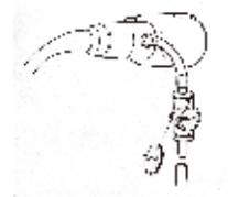
内視鏡の吸引口金にホルダーの接続チューブを差し込み、反対側に外部吸引チューブを接続してください。
