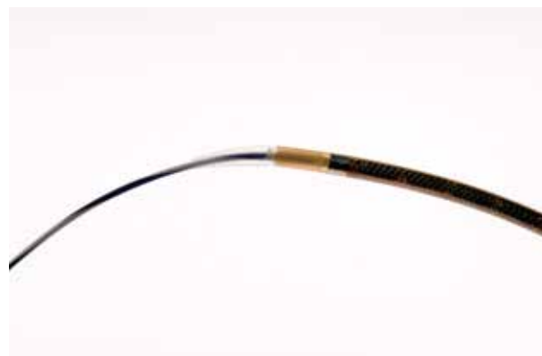
図 6 先端チップと 0.025 inch ガイドワイヤーとの段差を低減している
